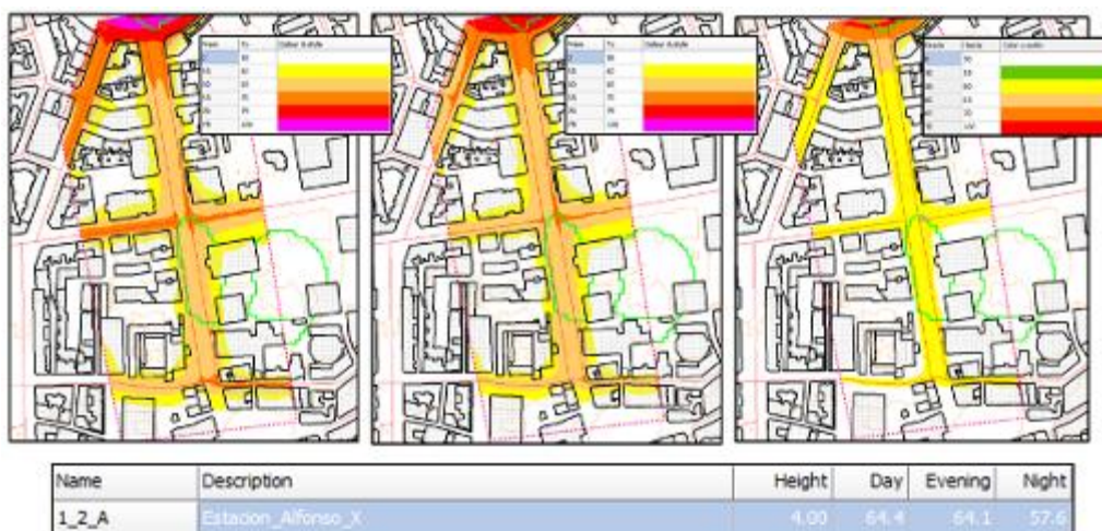
Imagen 10: Determinación de niveles acústicos asociados al tráfico en periodos día, tarde y noche, en Gran Vía Alfonso X y Estación 1.2. a 4m de altura.
