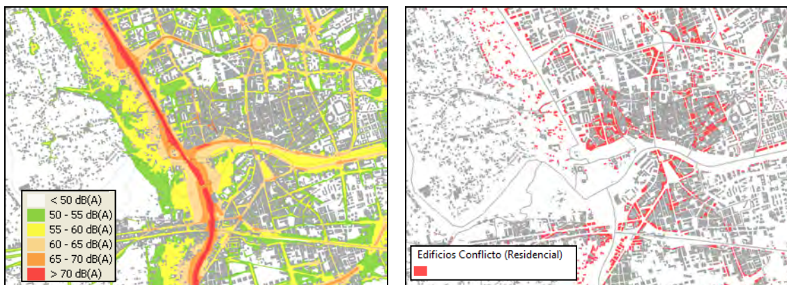
Ilustración 60: Zonas de conflicto en Ronda Oeste (A-30) – Centro de Murcia. (fracciones de edificios sometidos a niveles de ruido nocturnos superiores a 55 dB).
