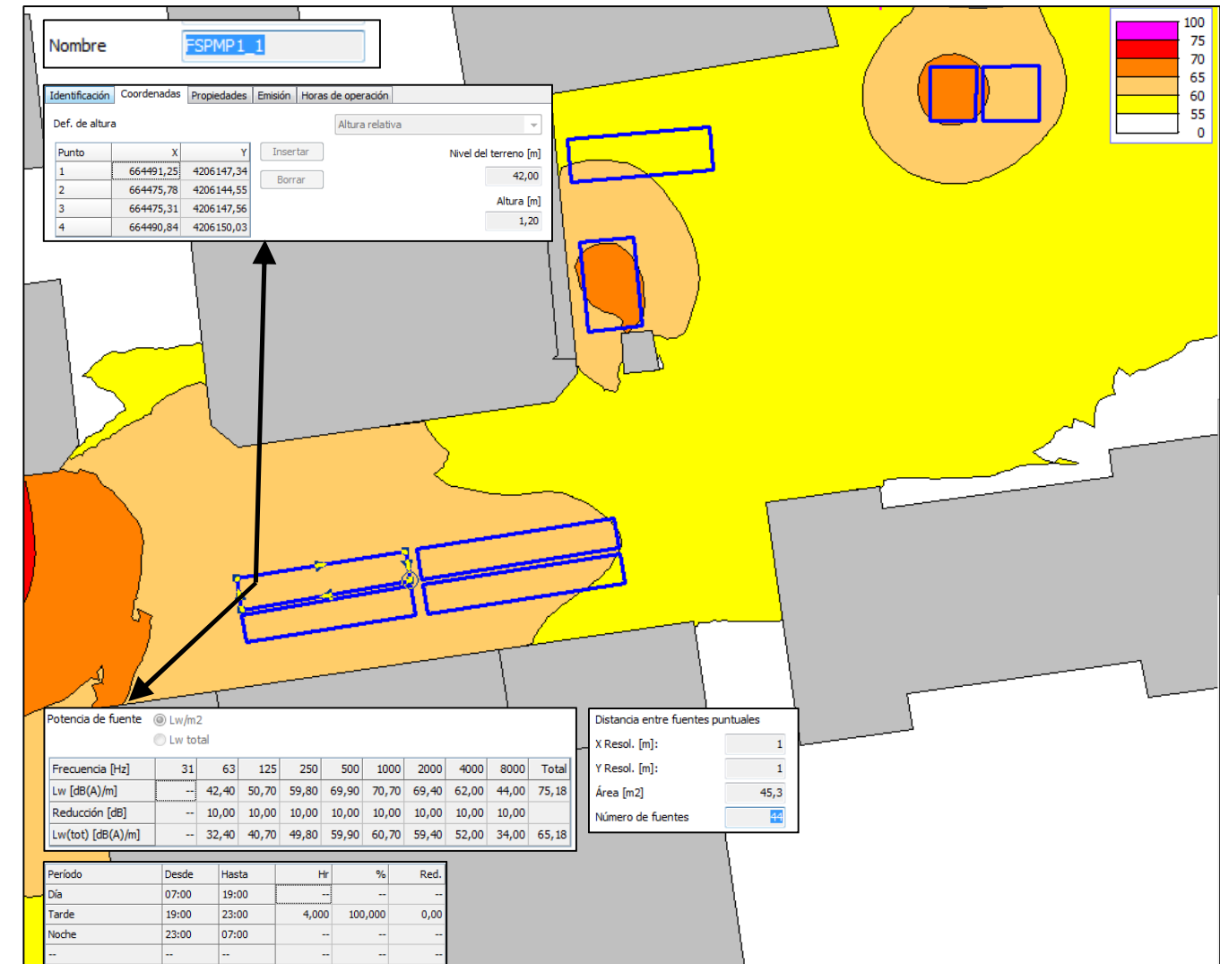
Imagen 30: Modelo definitivo calibrado, con geometría final y datos asociados para zona Plaza Universidad – Menéndez Pelayo en periodo tarde.
